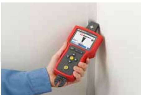
Verwenden der Sensorspitze zum Auffinden von Leitungen in schwer zugänglichen Bereichen.
