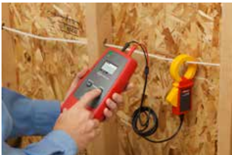
Induzieren des Signals mit der Stromzange, wenn nur isolierte Leiter vorhanden sind.
