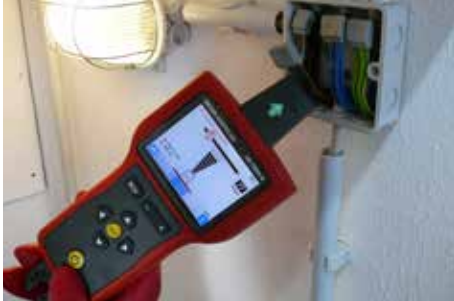
Auffinden spannungsführender oder spannungsfreier Leitungen durch Abnehmen der Verteilerkastenabdeckung.
